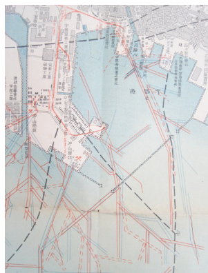
写真2 「宇部興業案内」昭和14年発行 (田村哲夫収集史料1252) 添付された平面図には、工場や火力発電所に取つかまされた宇部港と沖合海底に延伸した坑道が記録されている。
